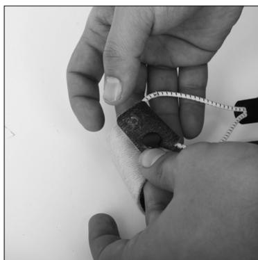
Das vormontierte I-Race System einlegen. Darauf achten, das Halteplättchen richtig herum zu positionieren. Dann die oberen Nieten auf die unteren handfest vordrücken und mit einem Hammer endgültig verschließen. Auf eine feste Unterlage achten.
