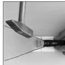
Entferne die Schutzfolie ca. 5 cm vom Fell. Lege es mit der Kleberseite nach oben in Längsrichtung auf die Einschlagunterlage. Schläge die Spitzen des Elastic Strap mit einem Hammer gerade durch das Fell.
